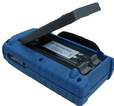
Figura 8-5 Rimuovere il coperchio del gruppo batterie senza rimuovere il supporto
