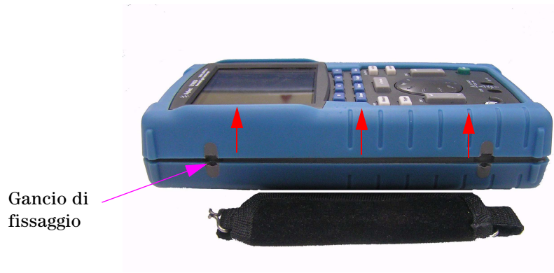
Figura 8-8 Rimuovere la maniglia dallo strumento
