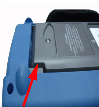
Figura 8-1 Spingere nel senso indicato dalla freccia per rimuovere il supporto
