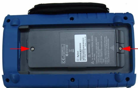
Figura 8-3 Rimuovere le viti del coperchio della batteria
