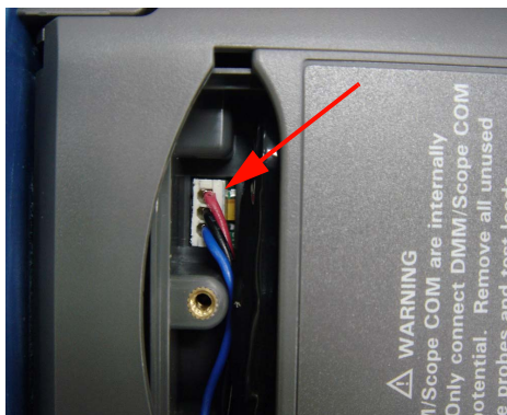
Figura 8-6 Scollegare il connettore a 3 fili con una pinzetta
