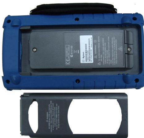
Figura 8-2 Disassemblare il supporto dallo strumento
